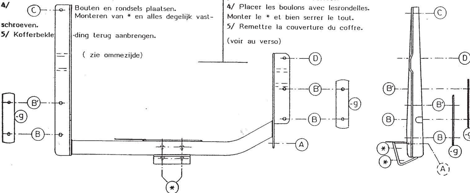
De door GDW gebruikte verf is enkel een grondlaag. Het is noodzakelijk na montage de trekhaak te voorzien van een extra beschermlaag. GDW a mis seulement une couche de peinture primaire. Il est nécessaire d'appliquer encore une couche supplémentaire après montage.
