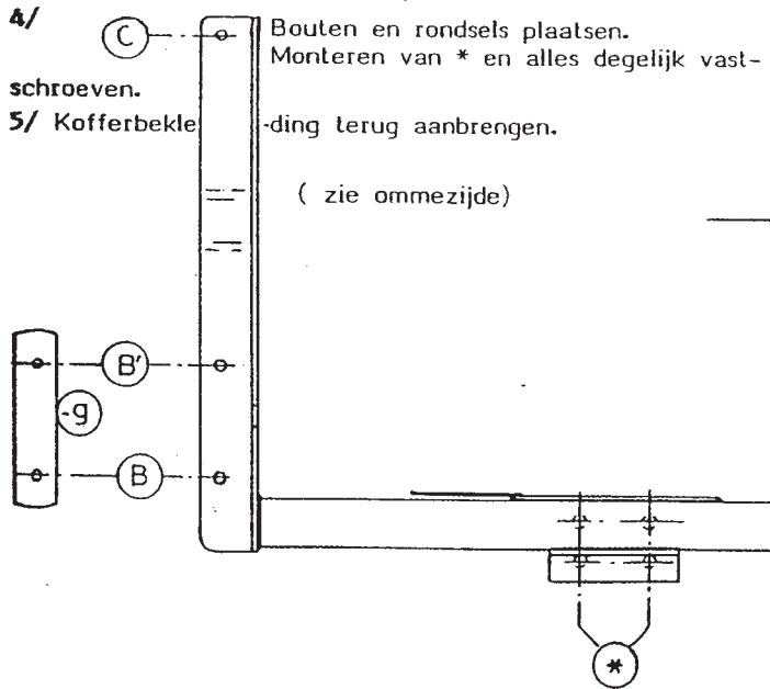
Bouten en rondsels plaatsen. Monteren van \* en alles degelijk vastschroeven.
